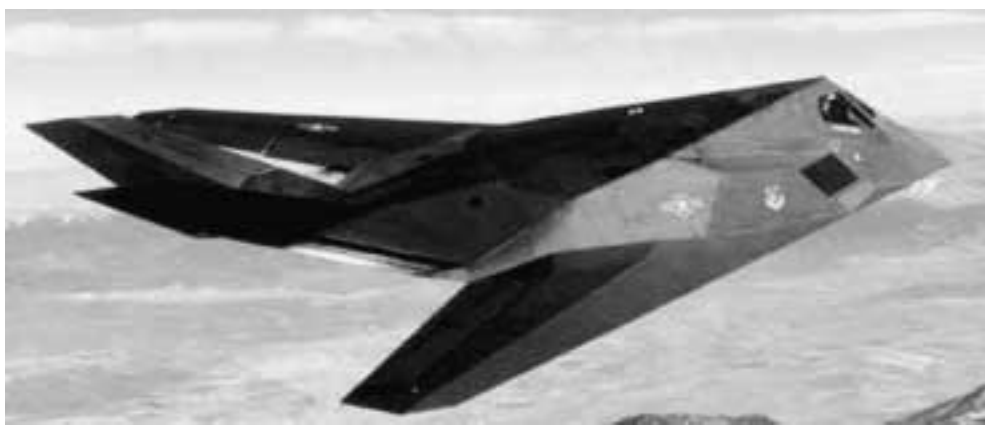
Amerikanskt attackflygplan F 117 i "stealth-teknik". Vapenlast ca 2 ton, radarmålarea som en liten fågel. "Elddop" under Gulfkriget 1991.
