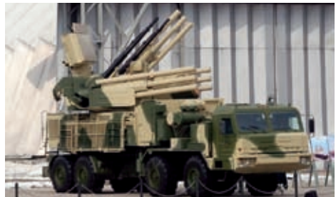
Pantsir-S1. Autonomt med alla delsystem i fordonet.
