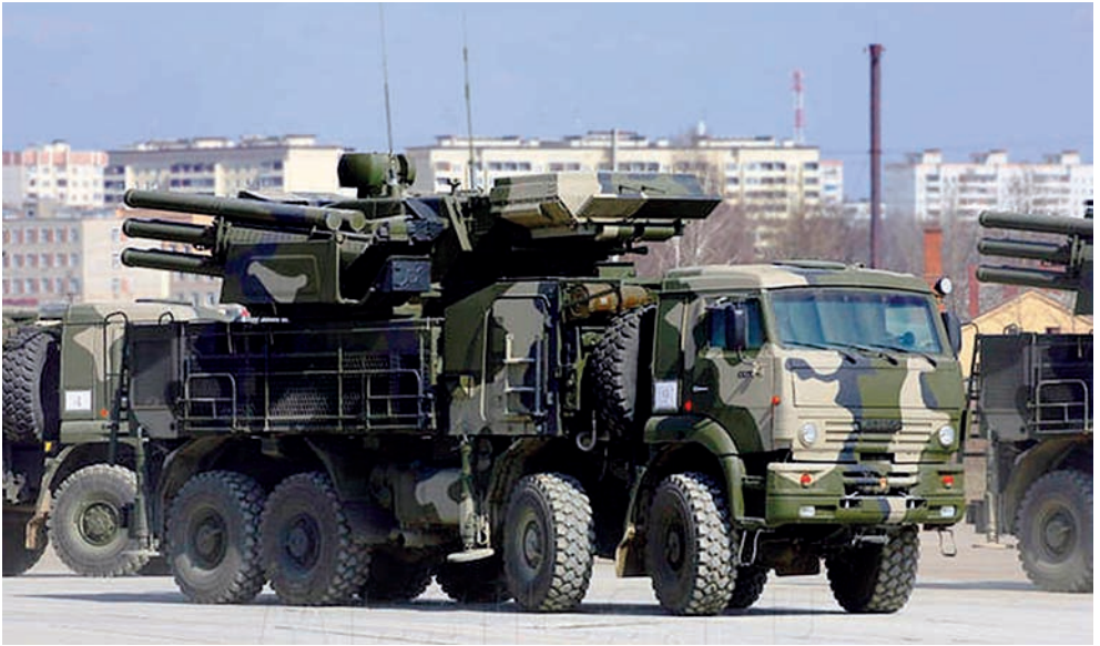
Luftvärnsrobotsystem Pantsir-S1 med dubbla 30 mm automatkanoner och 12 st. medföljande robotar.
