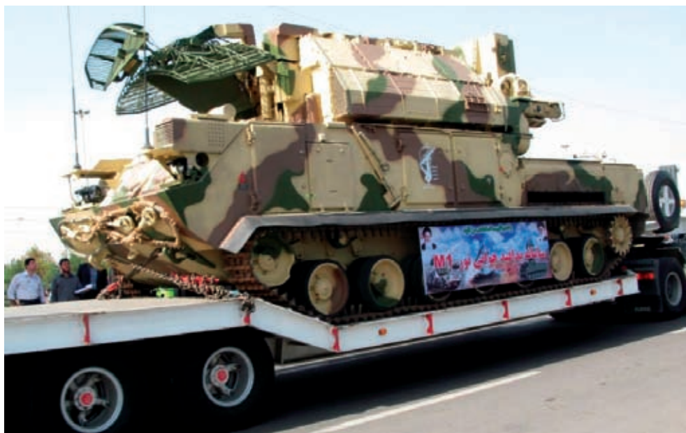
SA-15 (TOR-M1). Mobilt korträckviddigt lv-system med "alla" delsystem integrerade i vagnen.
