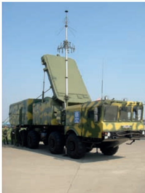
Spaningsradar till S-400-systemet. Räckvidd upp till 600 km.
