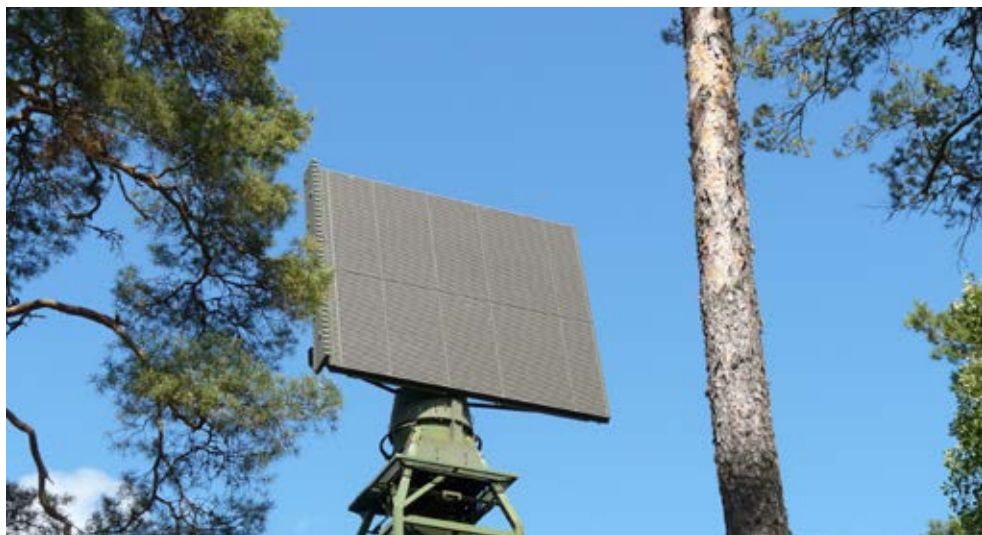
Befintlig radarstation Ps 861.
