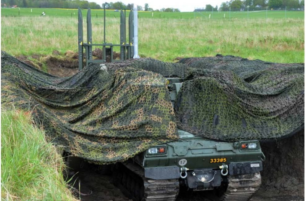
Nergrävd Eldenhet 98 med IRIS-T-robotar (Rb 98).
