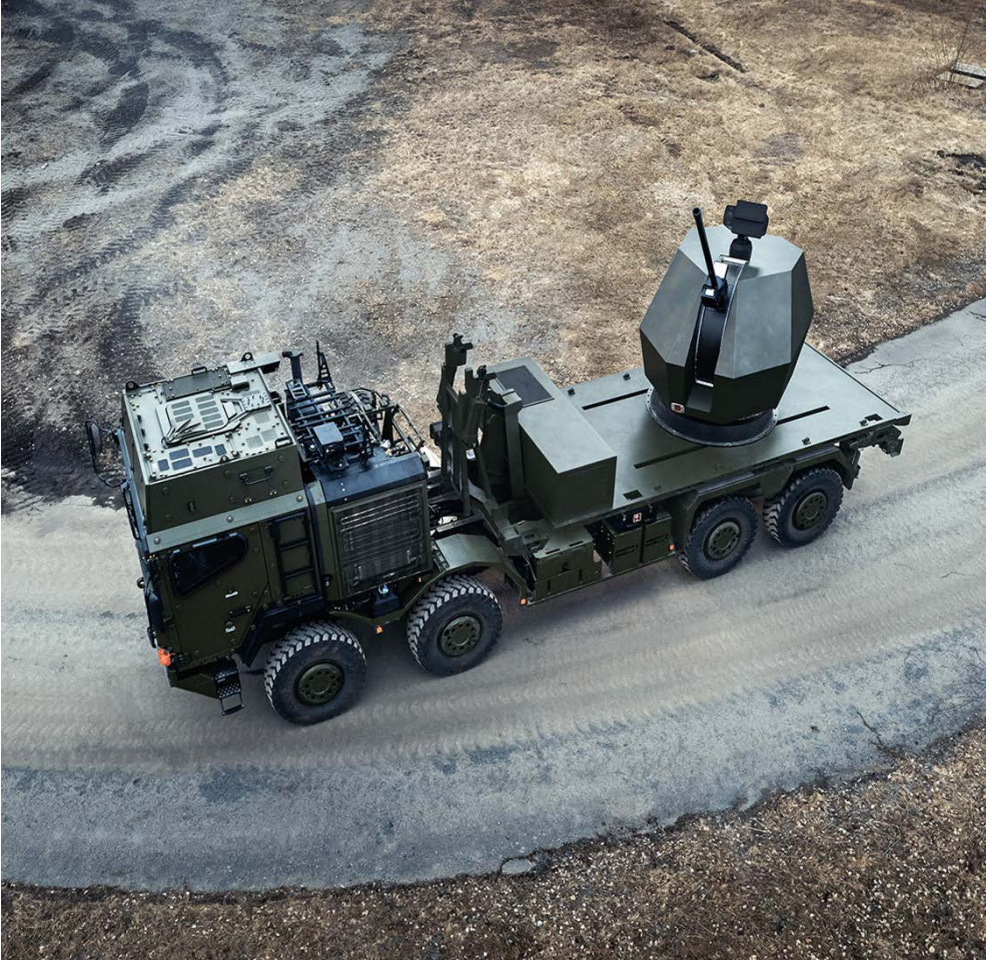
40 mm automatkanon Mk 4, fordonsmonterad.
