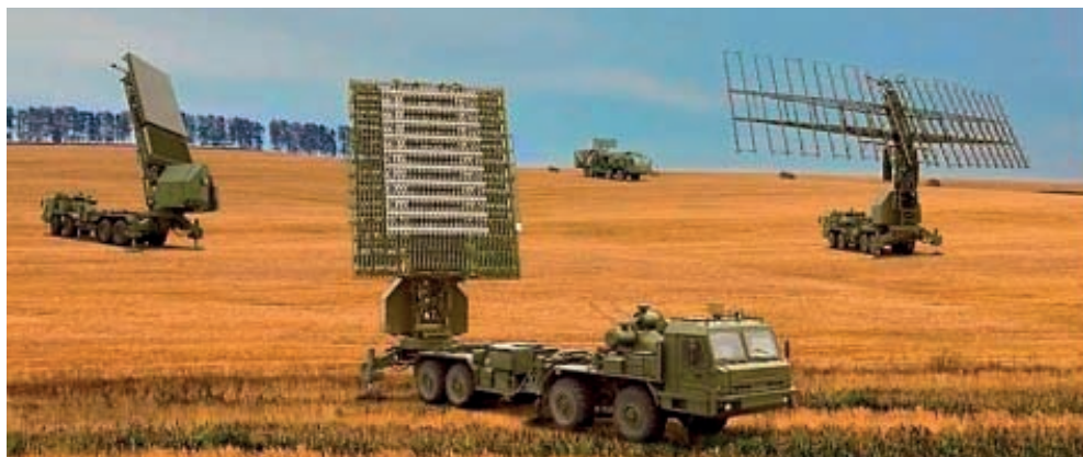
Ryskt radarsystem Nebo M. med tre separata mobila stationer inom olika frekvensområden. Från vänster: S/C-, L- respektive VHF-bandet. I bakgrunden skimtar ledningsfordonet.
